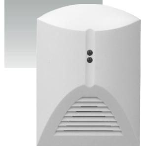
玻璃破碎探测器是对玻璃破碎作出报警反应的仪器，本产品使用高精度麦克风对周界的声音进行采集，得到的音频讯号经过滤波，放大处理后，送到微处理器进行分析、判断，最后通过外围输出设备输出判定的结果，有效的避免了误报发生。适用于银行、宾馆、仓库、家庭等场所的安全防范。
